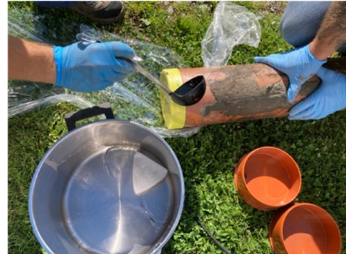
Liner mit Aquifermaterial wird mit Wachs versiegelt
