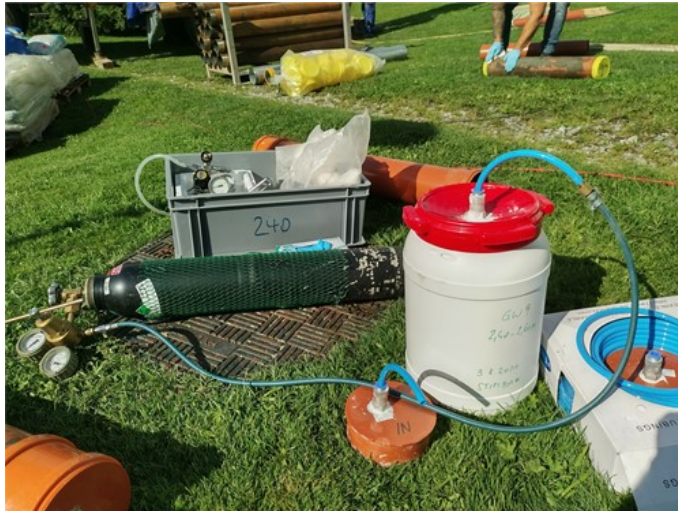
Container mit Aquifermaterial wird mit Stickstoff gespült
