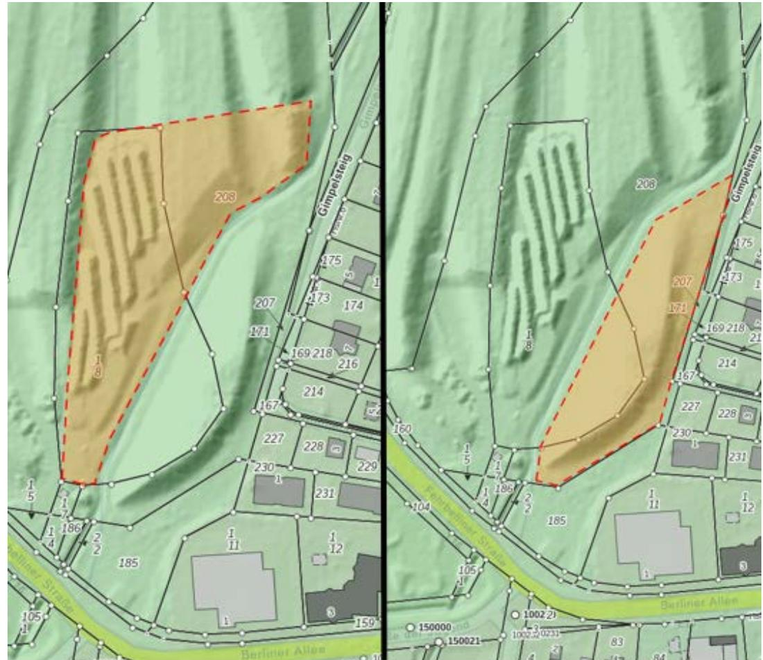
Flurstückskarte mit digitalem Geländemodell mit einer Fläche von ca. 9.800 m<sup>2</sup> (links) und einer Fläche von ca. 6.300 m<sup>2</sup> (rechts), welche nach Rückbau und Einebnung bebaut werden könnte.
