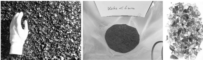
Abb. 3: Pyrolysat > 4 mm, Pyrolysat < 4 mm und aussortiertes Glas aus Pyrolysat > 4mm.
