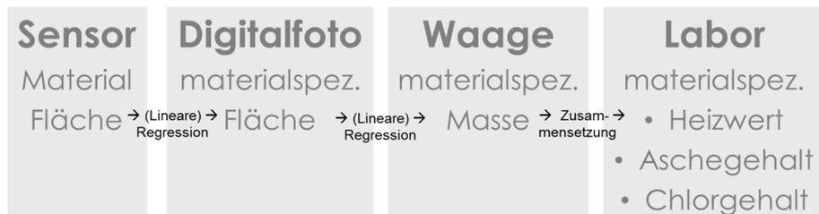
Abb. 1: Methodik der Regressionsanalyse zur Bestimmung der Brennstoffparameter.
