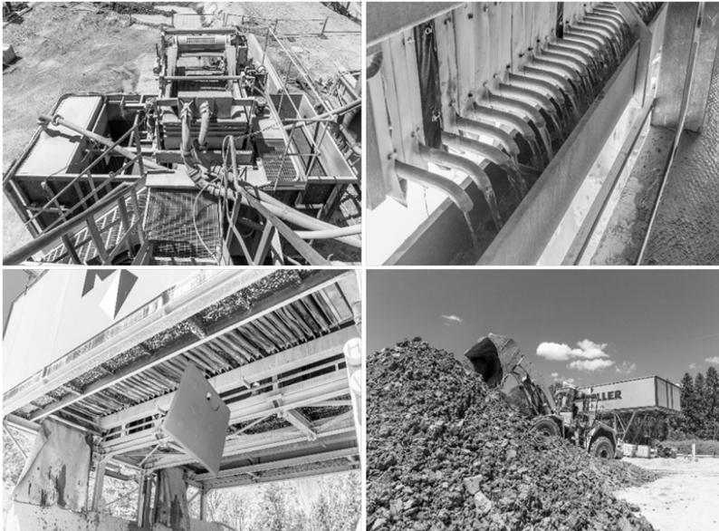
Abb. 4: Kammerfilterpresse.
