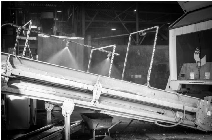
Abb. 3: Kühlprozess nach Auslösung des ersten Sensors.
