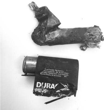
Abb. 1: Durch den mechanischen Aufbereitungsprozess beschädigte Akkus und Batterien stellen ein enormes Brandrisiko bei der Ersatzbrennstoffproduktion dar.
