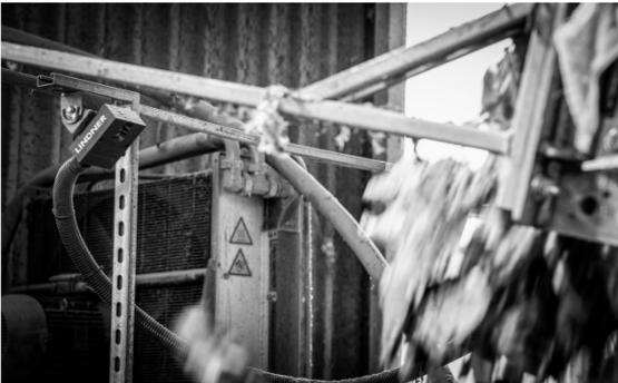
Abb. 4: Der Sensor des Lindner Feuer-Präventionssystem (FPS) nach der ersten Zerkleinerungseinheit erkennt überhitzte Partikel frühzeitig.
