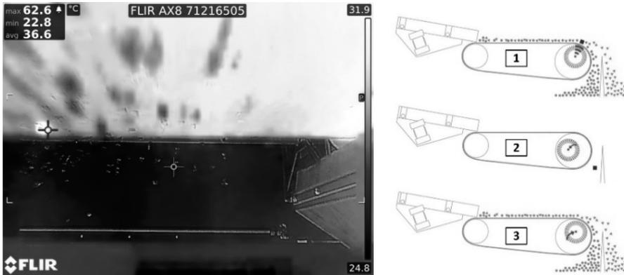
Abb. 4: Ein mittels Wärmebildkamera detektierter Störstoff am Förderband, gekennzeichnet durch das Fadenkreuz (links); Abfolge der Störstofferkennung und -austragung (rechts).
