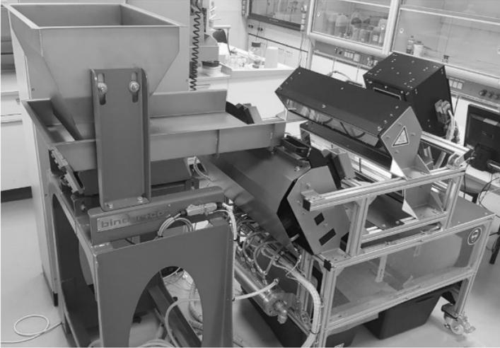
Abb. 9: Versuchstand für sensorgestützte Erkennung und Sortierung am Lehrstuhl für Abfallverwertungstechnik und Abfallwirtschaft (AVAW) der Montanuniversität Leoben.
