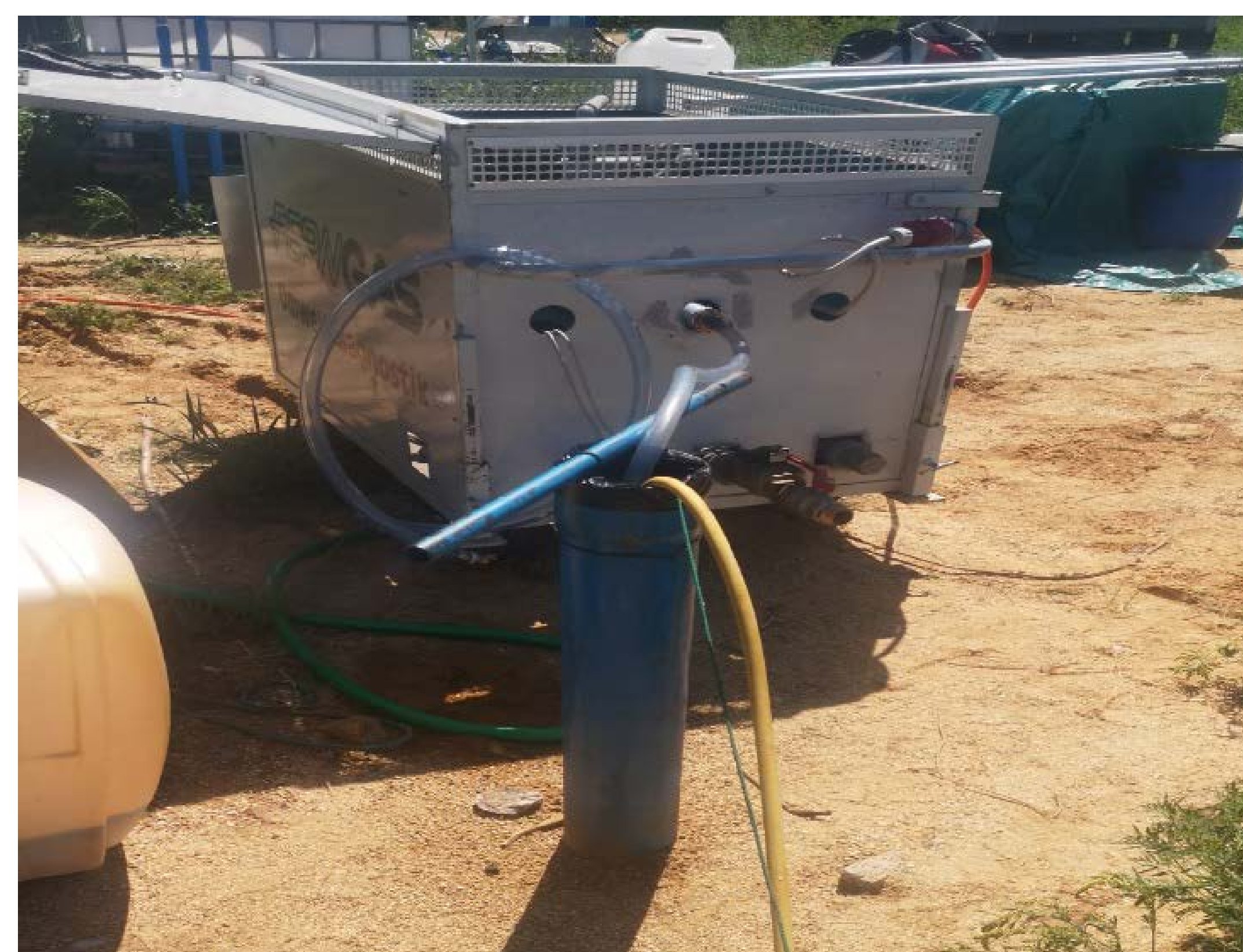
Versickerung der Emulsion (in F-DB; DB = Duobrunnen)
