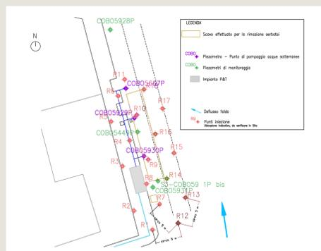
Abb. 2 Raster der 18 Injektionspunkte (rot) und der 4 Überwachungsstellen (grün) zusammen mit der Richtung der Kontaminationsfahne (Flap SN)
