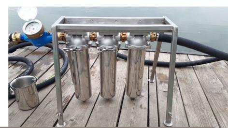
Pumpe zur fraktionierten Filtraion
