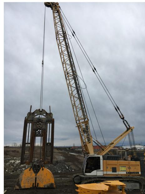
Abb. 3: Schlitzwandbagger mit Greiferschalen
