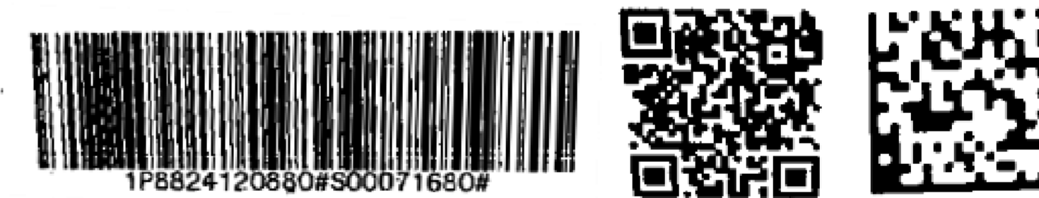
Beispielhafte Darstellung von 2D Codes auf Modulen (v.l.n.r.: Barcode, QR-Code, Data Matrix)
