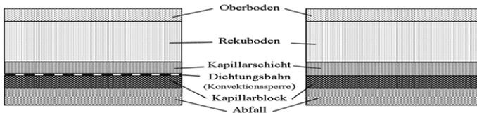
Abb. 1: Kombi-Kapillardichtung, Ausgangszustand, mit funktionsfähiger Konvektionssperre (Sehrbrock 2003)
