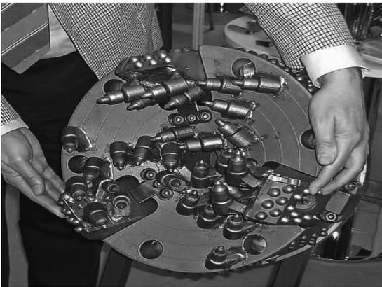
Abb. 4: Bohrkopf einer WHD-Anlage
