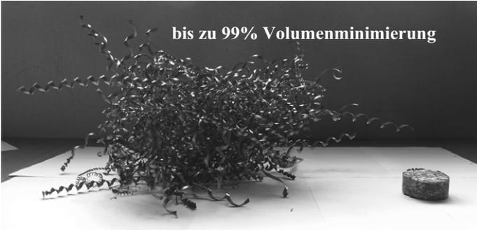
Abb. 5: Edelstahlspäne gewichtsgleich lose und brikettiert
