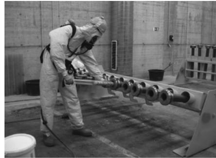
Abb. 5: Entleeren der Probenahmerohre
