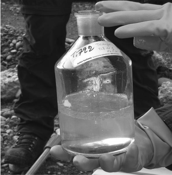
Abb. 2: Abgeschöpfte Petrolphase auf dem Grundwasserspiegel
