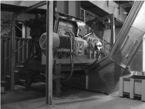
Abb. 4: „Rasor“, Nachzerkleinerer für die Ersatzbrennstoffaufbereitung
