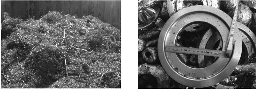
Abb. 8: Spänebüschel (links) und Grobteile (rechts)
