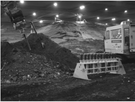
Abb. 4: Mechanische Probenahme mit Probenahmerohren
