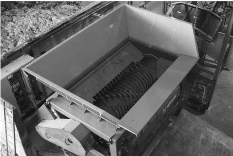
Abb. 2: „Terminator XF“, Vorzerkleinerer für die Ersatzbrennstoffaufbereitung
