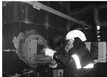
b) Einwurf einer Hg-Bombe am Fuß der Nachbrennkammer (Vosteen 2006a)
