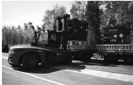
Abb. 6: Verladung gefüllter Container auf Bahnwaggons
