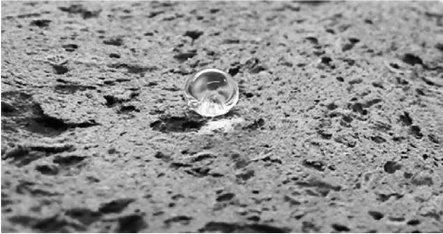
Abb. 3: Wassertropfen auf einer nahezu vollständig hydrophoben Papierschaumplatte.
