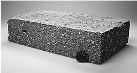
Abb. 2: Seitenansicht einer Papierschaumplatte mit einer 1 Eurocent Münze als Größenvergleich.
