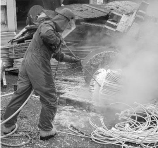
Abb. 3: Versuch Wasserstrahlschneiden für Entwicklung Seil/Netzvorbehandlungsanlage.
