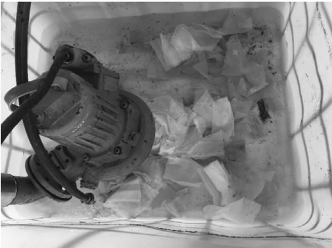
Abb. 3: Versuchsanlage zur Pumpenverstopfung durch FT.
