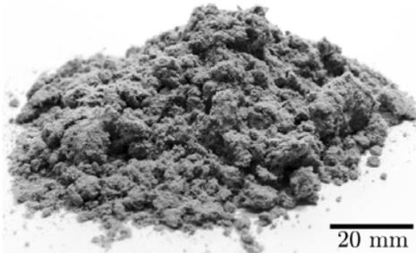
Abb. 1: Feinstofffraktion aus einem Aufbereitungsprozess von Altpapier.
