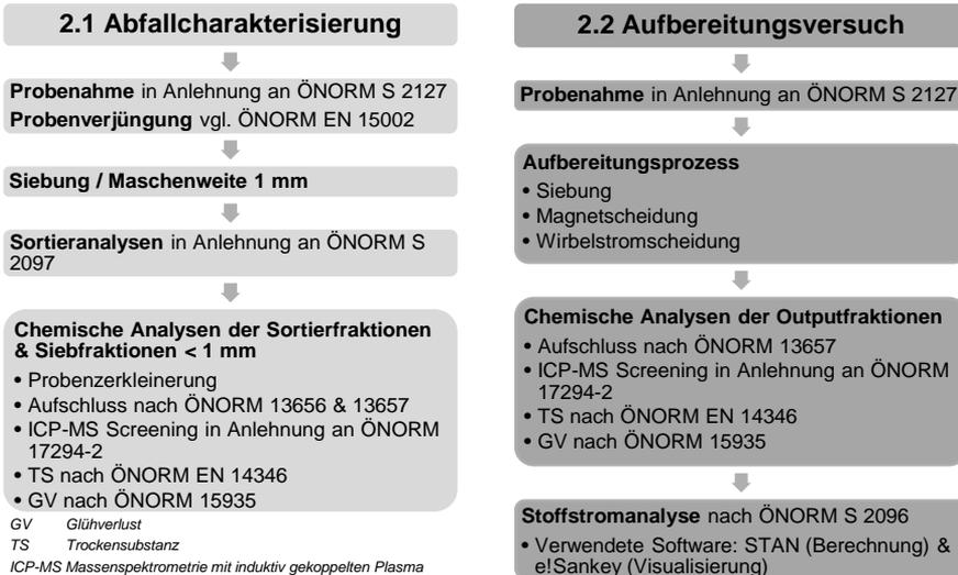
Abb. 2: Methodenübersicht – Abfallcharakterisierung und Aufbereitungsversuch.
