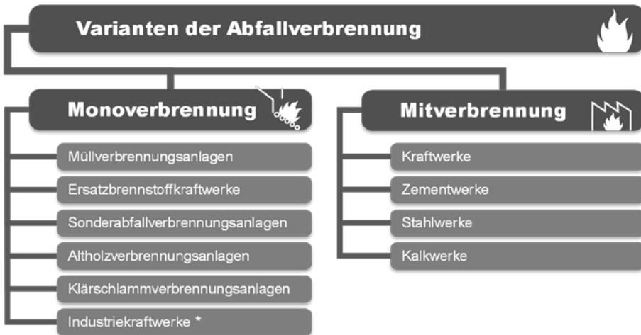
Abb. 2: Überblick über relevante Varianten der Abfallverbrennung.
