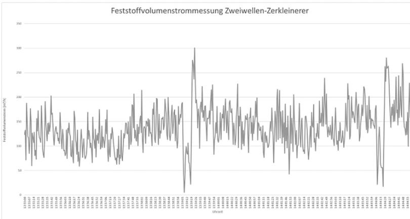
Abb. 5: Förderverhalten eines Zweiwellen-Kammwalzen-Zerkleinerers.
