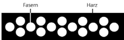
Abb. 1: Schematischer Aufbau von Faserverbundkunststoffen.
