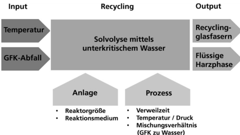
Abb. 2: Zentrale Parameter der Solvolyse.
