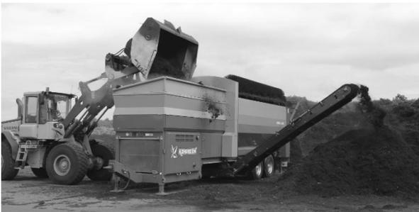
Abb. 2: Abschließendes Sieben bei der Aufbereitung von Bodenaushub zur Komposterde.
