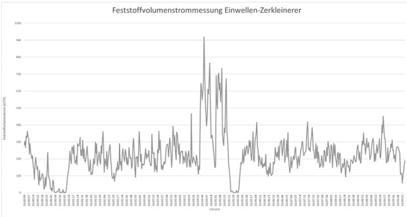
Abb. 4: Förderverhalten eines Einwellen-Kammwalzen-Zerkleinerers.
