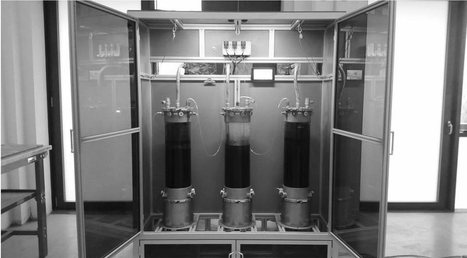
Abb. 1: Verfahrenskonzept bestehend aus links Rieselbett, UASB, rechts Anaerobfilter.
