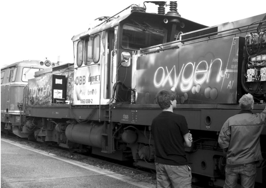
Abb. 4: Umgebaute Rangier-Lokomotive ÖBB 1063.038 mit seitlich angebautem Batteriesystem.
