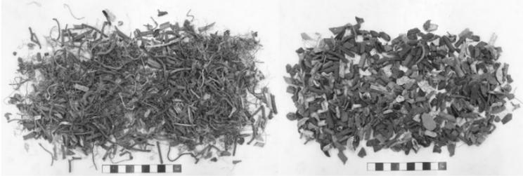
Abb. 6: Vergleich der Fraktionen 4 - 6,3 mm (links) und 6,3 - 8 mm (rechts) des Elektro(nik)-Schrotts.
