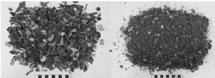
Abb. 2: Vergleich Inputmaterialien Elektro(nik)-Schrott (links) und Shredderschwerfraktion (rechts).
