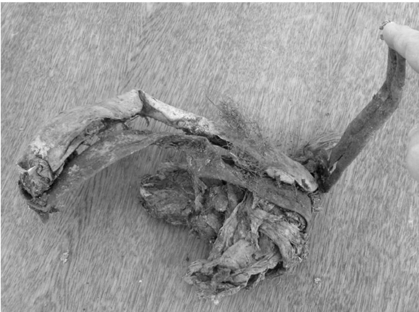
Abb. 2: Deformiertes Metallrohr mit Störstoffen.
