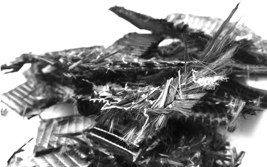
Abb. 2: CFK-Produktionsabfälle aus Österreich (nicht ausgehärtet, ohne Harz) (Foto: Schönmayr 2018).
