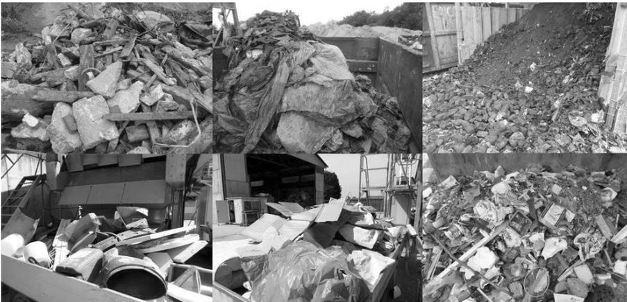
Abb. 6: Sortierte Fraktionen, oben: Deponieaushub, unten: Gewerbemüll (jeweils 3D, 2D, Absieb).
