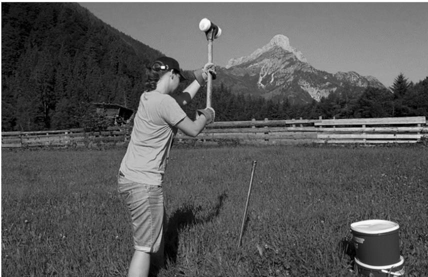
Abb. 3: Probenahme mit der Pürckhauer-Methode.
